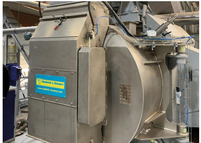
Die Pelletschnecke von Rudnick & Enners bei Holz-Henkel ist auf eine Leistung von 5,5 t/h ausgelegt
