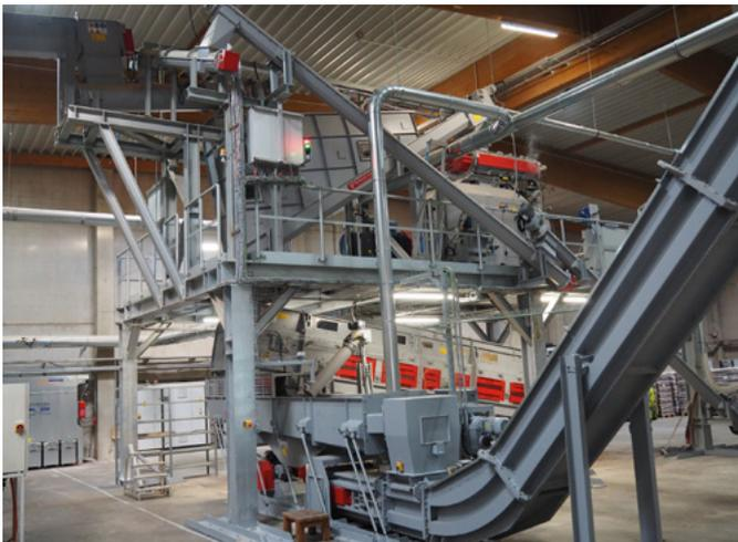
Kompakte, aber leistungsfähige Anlage: oben die Pelletschnecke, unten die Kühl- und Vibrationsrinne in den Silo
